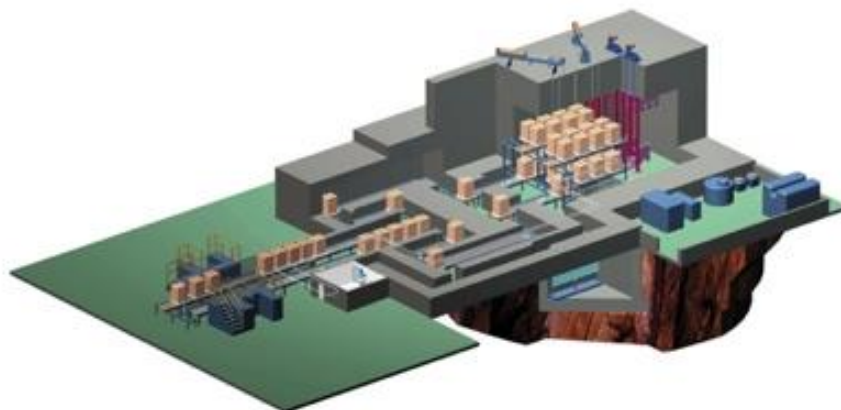
FIGURA 5 – ESQUEMA DE PLANTA DE IRRADIAÇÃO INDUSTRIAL
